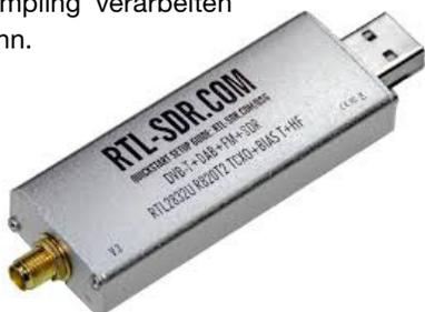
Unter dem Namen RTL-SDR V.3 sind inzwischen recht gute und kaum teurere Sticks mit einem 0,5 ppm TCXO im Metallgehäuse erhältlich (€ 15 bis € 20)<sup>1</sup>, die nach einiger Aufwärmzeit überaus frequenzstabil sind. Diese nicht TX-fähigen DVBT-Sticks eignen
